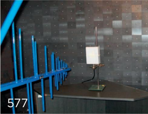
Experimentelle Versuche zu einem neuen Multilayer-Lack für verbesserte Schirmdämpfung haben vielversprechende Ergebnisse gebracht
