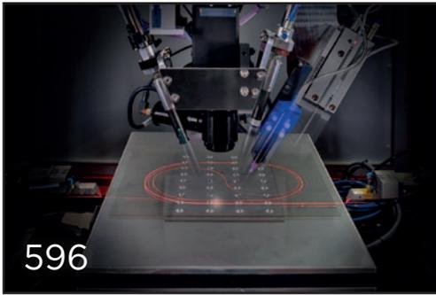
Glas als Baugruppenträger in der Elektronikfertigung ermöglicht höhere Datenübertragung - auch für KI-Anwendungen
