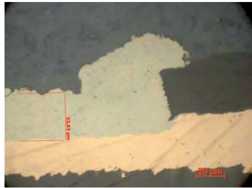
Abb. 9: Querschliffaufnahme Randbereich des chemisch abgeschiedenen Nickel-Phosphors mit 2,5 g/l \text{TiO}_2 , Luft-rührung, t_{\text{ex}} = 120 \text{ min}
