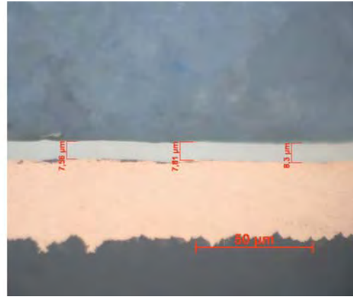
Abb. 5: Oberfläche (5a) und Schichtdicke (5b) der Nickel-Phosphor-Schicht t_{ex} = 30 min ohne TiO_2 -Zusatz
