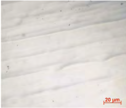
Abb. 5: Oberfläche (5a) und Schichtdicke (5b) der Nickel-Phosphor-Schicht t_{ex} = 30 min ohne TiO_2 -Zusatz
