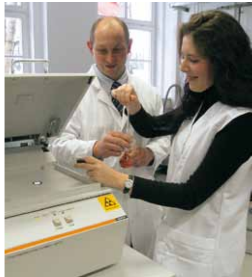
Praktikum zur Bestimmung von Elektrolytkonzentrationen mittels Röntgenfluoreszenz
